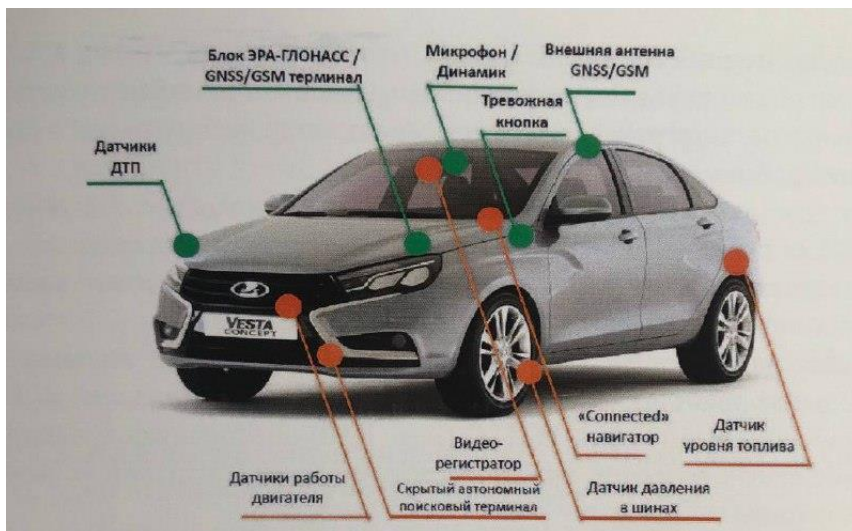
Рисунок 3.8 – Краткий состав автомобильной подсистемы на основе ЭРА-ГЛОНАСС
